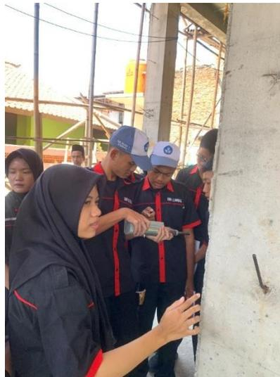
**Gambar 12 Pelatihan Pengujian Beton menggunakan Hammer Test**
