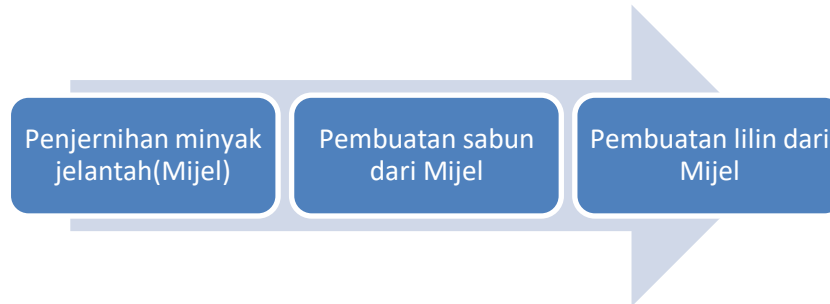
Gambar 1. Proses Pengolahan Limbah Minyak Jelantah menjadi Produk Bernilai Tambah
