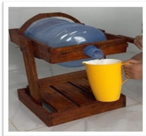
Gambar 3. Hasil Pembuatan Rak Penyimpanan Galon dari Limbah Palet
